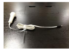
ナースコールボタン先端プラグの付替え (メタコンカット+別プラグ半田付) (介護系製品用途)
