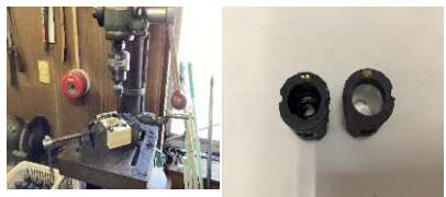
電子部品組立作業 (ハンドプレス機による圧入作業) (医療系製品用途)
